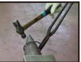
高温の材料をハンマー などで圧力を加えて変形
